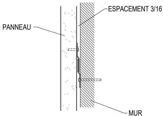
**DÉTAIL D'ANCRAGE AU MUR**
